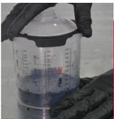
**3** Coloque a tampa sobre o copo, alinhe a zona preta do sistema de bloqueio da tampa com a janela de acesso ao copo e pressione a mesma para baixo. Rode para bloquear.
