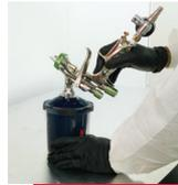
**5** Quando terminar a pulverização, desligue a linha de ar, inverta a pistola e aperte o gatilho, para eliminar o excesso de tinta do copo. Bata levemente na Tampa e Copo descartável PPS™ Versão 2.0 3M™ sobre uma superfície, para ajudar a quebrar a tensão superficial do líquido e deixe-o escorrer de volta ao copo.
