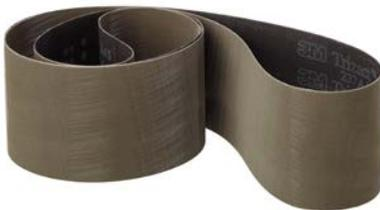
Das 3M™ Trizact™ Schleifband 237AA verfügt über eine geschützte Mikroreplikationstechnologie, bei der Aluminiumoxidpartikel in Micron-Qualität zu kleinen Pyramiden aus Schleifmineral geformt und dann auf einen X-Last-Gewebetragere aufgetragen werden. Während diese Pyramiden abgetragen werden, wird fortlaufend frisches, scharfes Mineral freigelegt, um einen gleichmäßigen Schnitt und ein planbares, genaues Finish zu erzeugen.
