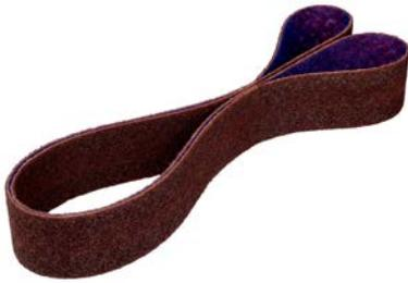
Das Scotch-Brite™ Vliesband DF-BL eignet sich ideal zum Entgraten, Mattieren und Finishen von sämtlichen Edelstahl- und Stahlbauteilen sowie Entfernen von Anlauffarben. Auch das Auftragen eines definierten Finish auf großen Flächen sowie Reduzierung der Rautiefe ist mit diesem Vliesband garantiert. Darüber hinaus kommt dieses Band auch auf Anwendungen auf Holz und Kunststoffen zum Einsatz.
