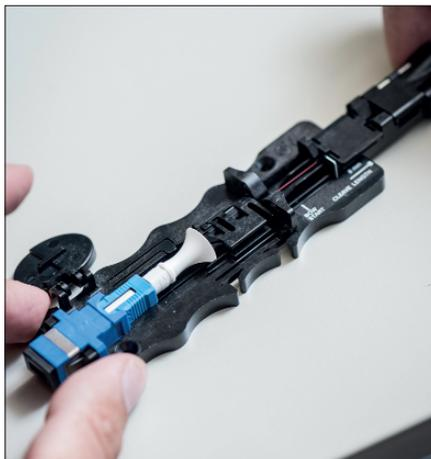
Bild 1: NPC-Stecker kombinieren eine hochpräzise Vorkonfektionierung ab Werk mit einfacher Montagetechnik
