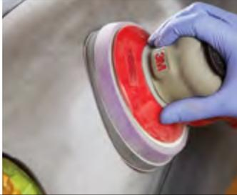
**Lixamento com Máquina da Área de Alongamento de Tinta**
