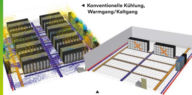
Server-Kühlung / GreenICE™-System von EXTOLL mit 3M™ Novec™ High-Tech Flüssigkeit
