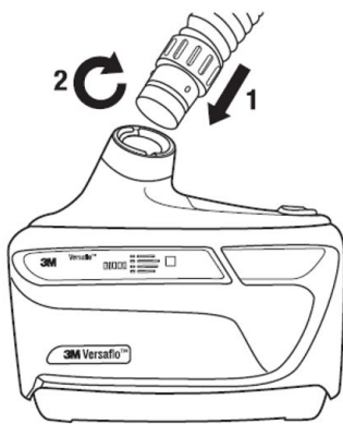
Fig. 10 – Installation du tuyau de respiration
