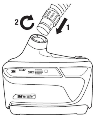
Fig. 10: Instalación del tubo de respiración
