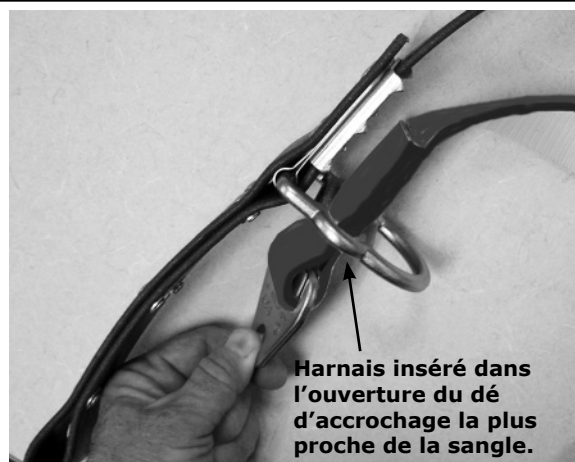
Figure 38 - Insérez la longe à sangle dans le dé d'accrochage fixe à œil.
