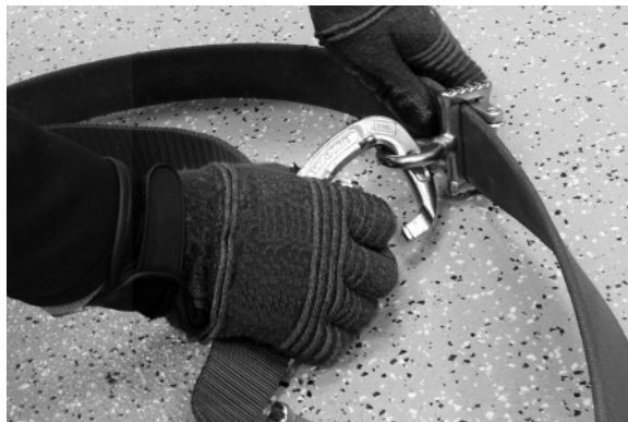
Figure 36 - Longe à corde ou à sangle, déconnectez le mousqueton à œil du réglage à galet Cynch-Lok.
