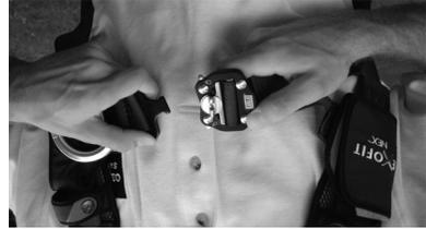
**Ajustement des sangles :** Faites tourner le verrou de la sangle en position déverrouillée □. Tirez sur la sangle pour l'ajuster. Faites tourner le verrou de la sangle en position verrouillée □.
