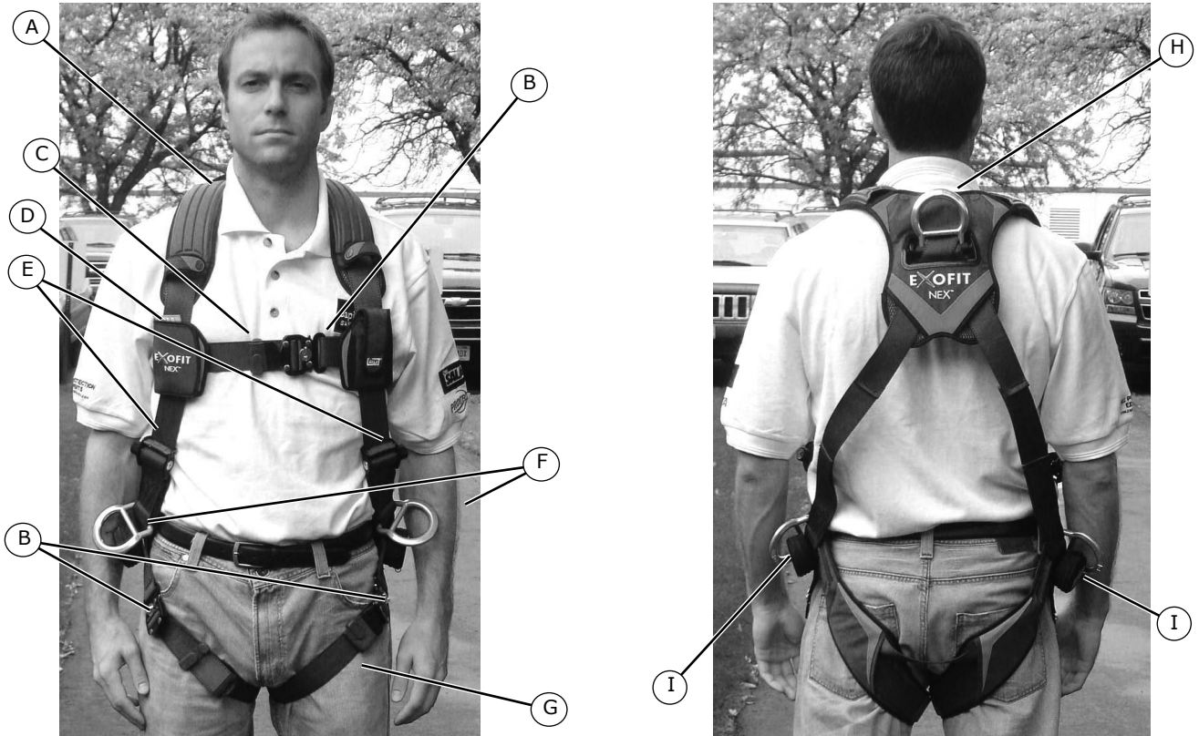
A. Bretelle avec rembourrage hybride B. Boucle à fermeture rapide Duo-Lok MC C. Sangle de poitrine D. Rembourrage hybride au niveau de la poitrine avec étiquettes IDRF i-Safe MC E. Système d'ajustement Revolver MC au niveau du torse F. Anneau en D latéral Tech-Lite MC G. Sangle de jambe H. Anneau en D dorsal Tech-Lite MC I. Courroie anti-traumatisme
