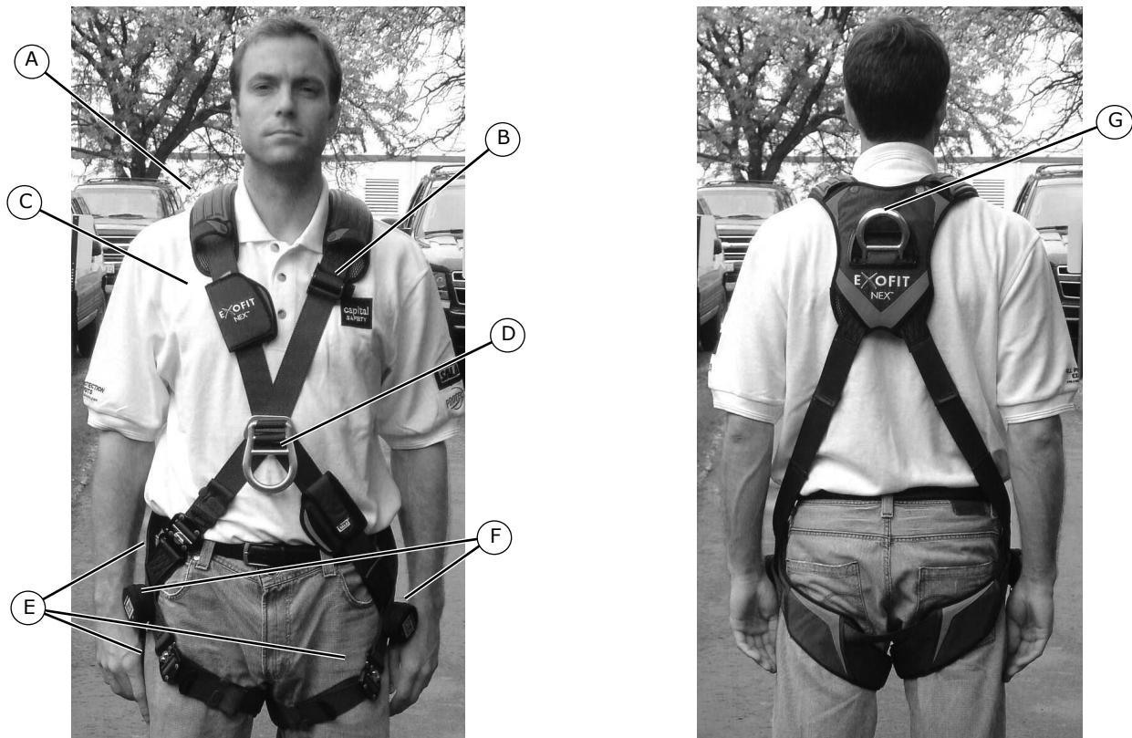
A. Bretelle avec rembourrage hybride B. Système d'ajustement Revolver MC C. Rembourrage hybride au niveau de la poitrine avec étiquettes IDRF i-Safe MC D. Anneau en D frontal Tech-Lite MC E. Boucle à fermeture rapide Duo-Lok MC F. Courroie anti-traumatisme G. Anneau en D dorsal Tech-Lite MC
