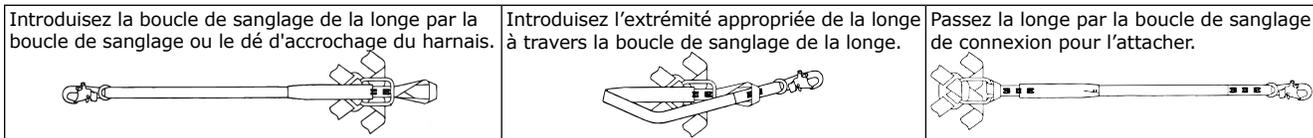
**2.7 FIXATION DE STATIONNEMENT DE LA LONGE :** La figure 7 représente les différentes fixations de stationnement de la longe. La fixation de stationnement de la longe est destinée à fixer l'extrémité libre d'une longe ou d'un dispositif auto-rétractable fixé sur un harnais lorsqu'il n'est pas connecté à un connecteur d'ancrage à des fins de protection antichute. Les fixations de stationnement de la longe ne doivent jamais être utilisées comme élément de fixation de protection antichute.
