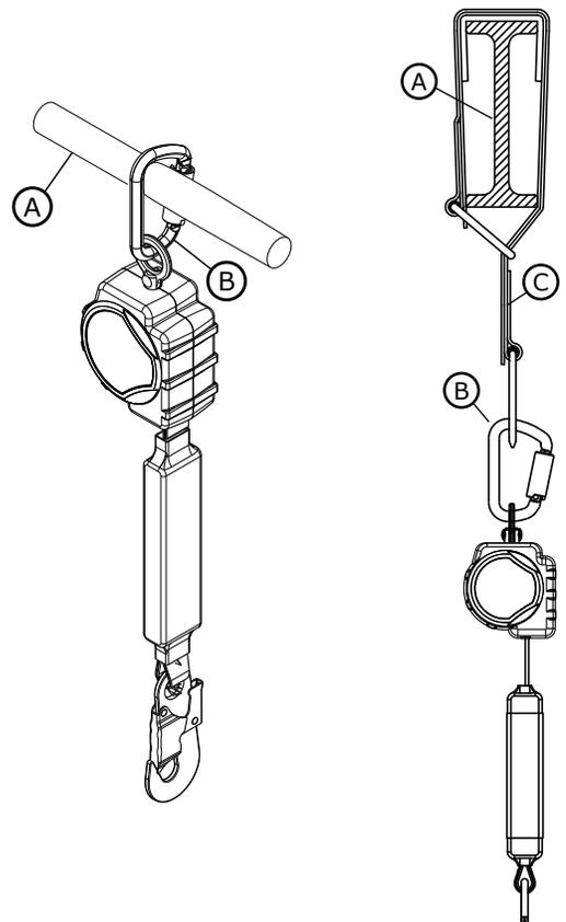
A - Ancrage B - Connecteur C Fixation universelle
