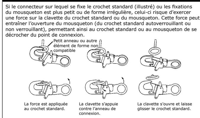
**Figure 5 - Connexions inappropriées**
