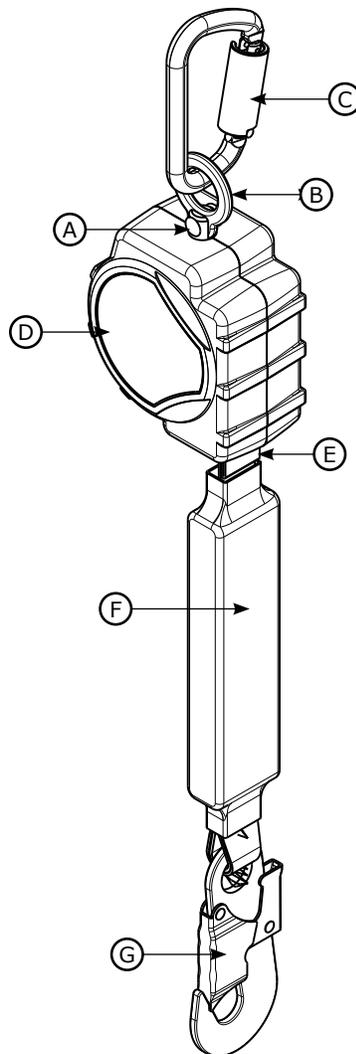
**A - Pivot B - Émerillon C - Mousqueton D - Carter E - Ligne de vie en fil tissé F - Absorbeur d'énergie G - Crochet standard**
