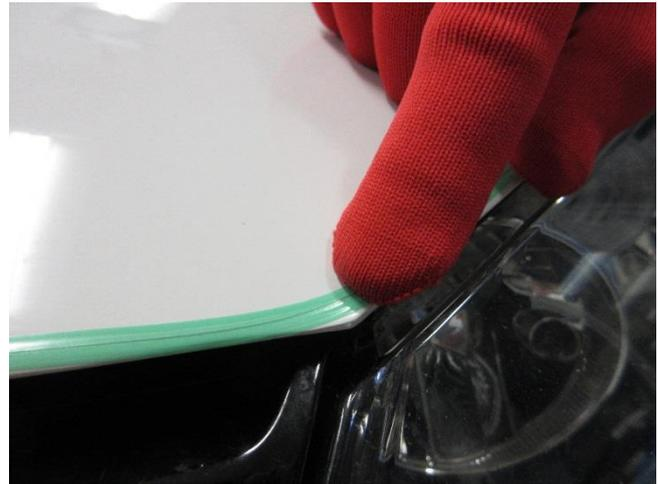
L'utilisation d'outils spéciaux d'application permet d'éliminer l'air sous le ruban support.
