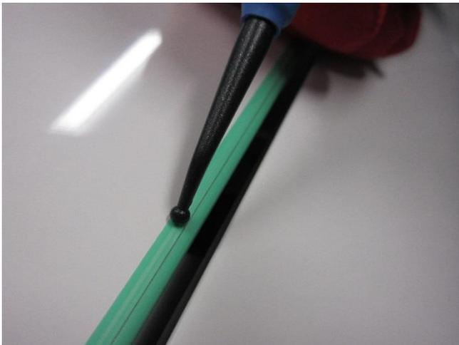
Appliquer le film 3M™ Paint Protection Film en exerçant une pression ferme sur le Knifeless Tape, en laissant l'amorce et la fin de celui-ci visibles, conformément aux instructions d'application humide.
