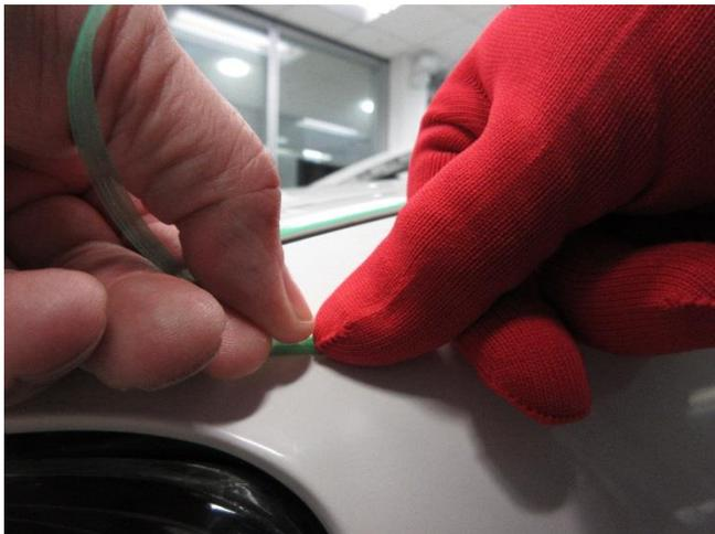
Tirer doucement sur le 3M™ Knifeless™ Tape pour libérer le filament et le séparer de son ruban support. Repositionner l'extrémité du filament sur le véhicule jusqu'à ce la coupe du film soit prête à être effectuée.
