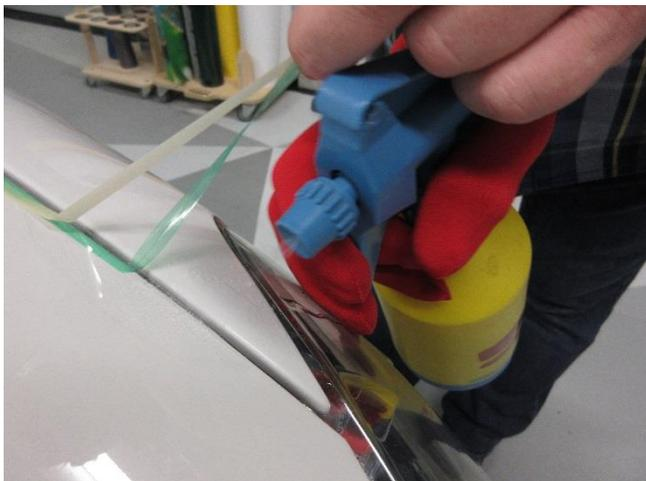
Appliquer le bord du film sur le substrat en le pressant à nouveau à l'aide d'une raclette.
