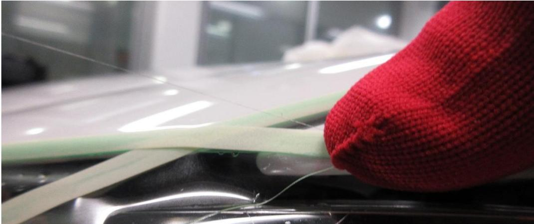
Tirer en arrière et non vers le haut le filament dans la direction de la ligne de coupe.
