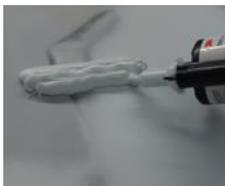
Mantenga la punta de la boquilla siempre en el material. Sitúe las gotas de material unas junto a otras.
