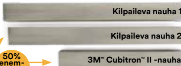
Kuvassa on kolme samanlaista ruostumattomasta 304-teräksestä valmistettua tankoa yhdeksän 10 sekunnin mittaisen ja samalla paineella tehdyn hionnan jälkeen. Tässä ajassa Cubitron II -nauha poisti 50 % enemmän ainetta kuin niin kutsuttu "uuden sukupolven" keraamisilla hiomajyvillä varustettu hiomanauha.
