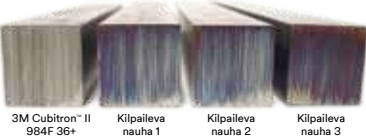
Kuvassa on neljä samanlaista ruostumattomasta 304-teräksestä valmistettua tankoa yhdeksän kertaa toistetun 10 sekunnin mittaisen hionnan jälkeen. Kolmessa perinteisillä keraamisilla hiomanauhoilla hiotussa tangossa näkyy eri asteisia hapettumisen merkkejä, mutta Cubitron II -nauhalla hiotussa tangossa ei näy lämpövaikutuksia.
