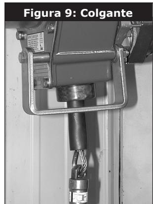
**Paso 1.** Fije el soporte a la cuerda SRL introduciendo los dos tornillos provistos en los orificios de la caja de la cuerda SRL. Coloque las tuercas y apriételas.
