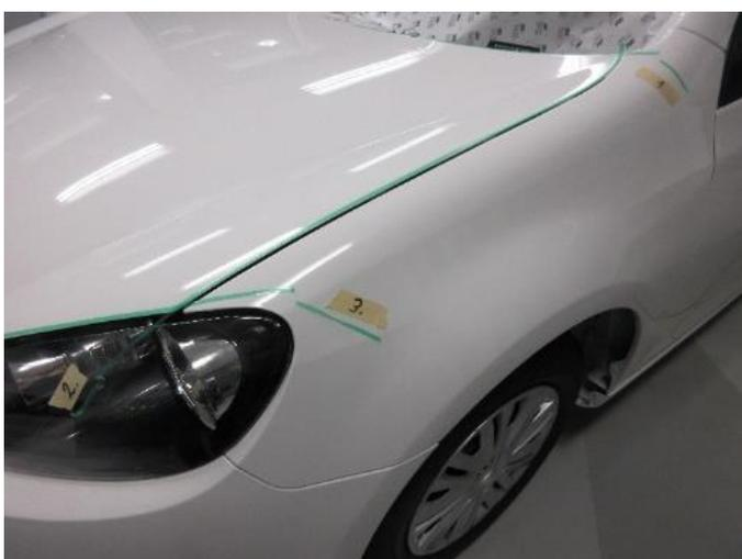
Premere nuovamente il nastro 3M™ Knifeless™ per ottenere una buona adesione al substrato.
