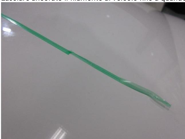
Applicare la pellicola con una forte pressione sul nastro, lasciando visibili la testa e la coda del nastro. Per rimuovere le bolle d'aria, premere nuovamente la pellicola sul nastro 3M™ Knifeless™ con le dita.
