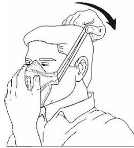
3. Com a outra mão, segure os dois elásticos e leve o respirador ao rosto, de modo que a aba inferior fique em contato com o queixo e que a espuma esteja sobre o nariz, passando os dois elásticos sobre a cabeça.
