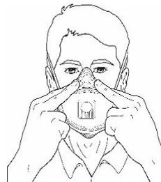
6. Coloque as pontas dos dedos de ambas as mãos na parte superior do clipe nasal (peça metálica recoberta). Deslize as pontas dos dedos por toda a extensão do clipe nasal, do centro para as extremidades, moldando-o de acordo com o formato do nariz. (Pictograma de atenção) Utilize as duas mãos para ajustar o clipe nasal. O uso de apenas uma das mãos pode causar um ajuste inadequado e prejudicar a vedação e o desempenho do respirador.
