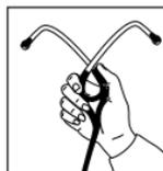
Um die Federspannung zu erhöhen, die Ohrbügel am Übergang in die Schläuche festhalten und zusammendrücken, bis sich die Schläuche der Ohrbügel gegenseitig berühren. Den Vorgang eventuell wiederholen.
