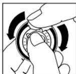
Breng met de vingertop een kleine hoeveelheid talk aan op de binnenkant van de buigzame rand van het membraan. Dit vergemakkelijkt het aanbrengen en zorgt voor een soepele en stille afwisseling tussen lage/hoge frequenties. Tik met de vingers tegen het membraan om de overtollige talk te verwijderen.
