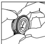
För att fästa membran-ringens-heten på bröststycket, passa in ringfåran (med membranet fastsatt) vid en punkt på bröststycket och håll det på plats med tummarna.
