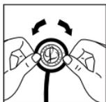
Pidä kuuntelukalvopuolta ylöspäin, tartu renkaaseen kummankin käden peukalolla ja etusormella ja pyörytä rengas irti rintakappaleen reunasta. Irrota kalvo renkaasta ja puhdista osat saippuavedellä tai alkoholilla pyyhkimällä. Rintakappaleen pinnat voidaan puhdistaa pyyhkimällä alkoholilla tai saippuavedellä. Kuivaa kaikki osat ja pinnat perusteellisesti ennen uudelleen kokoamista.
