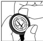
Kontroller at membranen sitter jevnt i festeringen. Mindre justeringer kan gjøres ved å dra forsiktig i ringen og rulle den bort fra membranen, slik at membranen sklir på plass.
