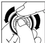
Verteilen Sie mit der Fingerspitze eine kleine Menge Talkumpuder auf der Innenseite des flexiblen Rands der Membran. Dies erleichtert den Zusammenbau und gewährleistet eine weiterhin gute Umschaltung zwischen hohen und niedrigen Frequenzen. Überflüssiges Talkumpuder durch leichtes Klopfen mit dem Finger von der Membran entfernen.
