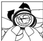
Skjut in den mjuka membrankanten i ringfåran. Detta görs lättast genom att börja med kanten ovanför membranets läsliga sida.
