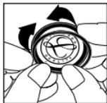
Den flexiblen Membranrand in die Ringrille einsetzen. Der Ring sollte zuerst über die beschriftete Seite der Membran positioniert werden.
