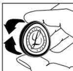
Deve verificar o aro para se certificar que a extremidade se encontra devidamente ajustada no interior do revestimento do aro. Caso seja necessário, deve ajustar o conjunto apertando a extremidade do aro exterior entre o polegar e os outros dedos. Deve repetir este último passo após ter rodado o conjunto cerca de um quarto.
