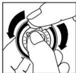
Påfør en liten mengde talkum med fingeren langs innsiden av membranens fleksible kant. Dette vil gjøre påsettingen enklere og opprettholde en myk frekvensveksling mellom høye og lave frekvenser. Sett membranens fleksible kant inn i sporet på festeringen.
