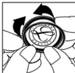
Insira a extremidade flexível da membrana na ranhura do revestimento do aro. Para efectuar melhor esta operação, deve iniciá-la tendo o aro posicionado para cima do lado legível do diafragma.
