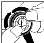
Rodar lentamente o aro à volta da campânula utilizando ambos os polegares, seguindo em direcções opostas à volta da campânula.
