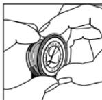
Pour attacher l'assemblage bague/membrane au pavillon, engagez la rainure de la bague (avec la membrane attachée) sur le pourtour du pavillon et maintenez l'assemblage en place avec vos pouces.
