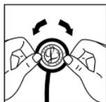
La membrane étant orientée vers le haut, poussez la bague à l'aide des deux pouces et détachez-la du bord du pavillon. Retirez la membrane de la bague et nettoyez les différentes pièces dans de l'eau savonneuse ou avec un chiffon imbibé d'alcool. Les surfaces du pavillon peuvent être essuyées avec un chiffon imbibé d'alcool ou d'eau savonneuse. Assurez-vous que toutes les pièces sont sèches avant de les réassembler.
