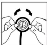
Håll bröststycket med membranet uppåt, fatta tag i ringen med båda händernas tumme och pekfinger och rulla av den från bröststycks-kanten. Avlägsna membranet från membranringen och rengör delarna med tvålvatten eller torka av dem med alkohol. Bröststyckets ytor kan också torkas av med alkohol eller tvålvatten. Torka alla delar och ytor ordentligt innan bröststycket monteras ihop igen.
