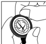
Inspecione a extremidade onde o diafragma encaixa no aro para um ajuste uniforme. Ajustes leves podem ser efectuados, puxando e fazendo rodar ligeiramente o aro para fora da membrana, permitindo que este mantenha a posição correcta.
