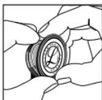
Pour attacher l'assemblage bague/membrane au récepteur, engagez la rainure de la bague (avec la membrane attachée) sur le pourtour du récepteur et maintenez l'assemblage en place avec vos pouces.
