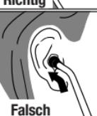
Ihr neues Littmann-Stethoskop ist so konstruiert, dass es sich dem Ohr äußerst bequem anpasst und akustisch abgedichtet ist. Die Ohrbügel sind in einem anatomisch korrekten Winkel geformt. Die Ohroliven müssen beim Einsetzen in die Gehörgänge nach vorne gerichtet sein.
