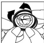
Inserire il bordo flessibile del diaframma nella scanalatura della ghiera. L'operazione riuscirà meglio iniziando con la ghiera posizionata al di sopra della faccia leggibile del diaframma.
