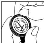
Kontroller at membranen sitter jevnt i festeringen. Mindre justeringer kan gjøres ved å dra forsiktig i ringen og rulle den bort fra membranen, slik at membranen skir på plass.
