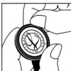
Inspecteer visueel de rand waar het membraan vaststeekt in de ring om te zien of het geheel gelijkmatig vastzit. U kunt kleine aanpassingen doen door de ring enigszins van het membraan weg te trekken en te rollen, waardoor het membraan op zijn plaats kan glijden.
