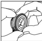
Um Ring/Membran am Bruststück zu befestigen, die Ringgrille (mit der befestigten Membran) an einer Stelle im Rand des Bruststücks einsetzen und mit dem Daumen festhalten.
