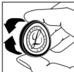
Deve verificar o aro para se certificar que a extremidade se encontra devidamente ajustada no interior do revestimento do aro. Caso seja necessário, deve ajustar o conjunto apertando a extremidade do aro exterior entre o polegar e os outros dedos. Deve repetir este último passo após ter rodado o conjunto cerca de um quarto.
