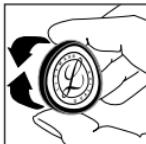
Kontrollera ringen så att den mjuka membrankanten är jämnt ihoppassad på ringens insida. Om det är nödvändigt, böj på membran-ringhenheten genom att knipa ihop den ytter ringkanten mellan tummen och fingrarna. Vrid membran-ringhenheten ett kvarts varv och upprepa förfarandet.
