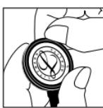
Kontrollera kanten där membranet har kontakt med ringen och försäkra dig om att membranet är jämnt ihoppassat i ringfåran. Mindre justeringar kan göras genom att lätt dra och rulla ringen ifrån membranet och på så sätt få membranet att glida fast i rätt läge.
