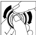
Du bout des doigts, appliquez une petite quantité de talc sur la surface intérieure du bord flexible de la membrane. Ceci facilitera l'assemblage tout en maintenant l'alternance des basses/hautes fréquences. Tapotez la membrane avec vos doigts pour retirer l'excès de talc.
