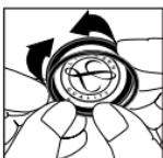
Leg de buigzame rand van het membraan in de gleuf van de ring. Dit lukt het beste wanneer u begint met de ring boven het leesbare gedeelte van het membraan.
