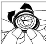
Insira a extremidade flexível da membrana na ranhura do revestimento do aro. Para efectuar melhor esta operação, deve iniciá-la tendo o aro posicionado para cima do lado levigável do diafragma.
