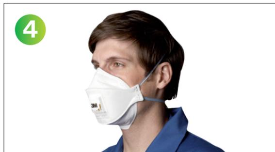
4. Positionner l'élastique supérieur au sommet de la tête et l'élastique inférieur sous les oreilles. Les élastiques ne doivent pas être enroulés. Ajuster les panneaux au visage en utilisant la languette de mise en place. Vérifier que les trois panneaux sont dépliés.
