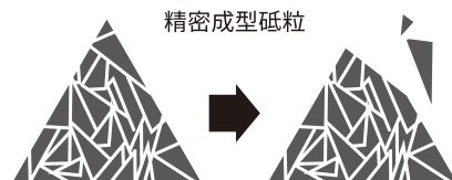
精密成型砥粒 シャープなエッジを維持しながら微細に消耗していく。
