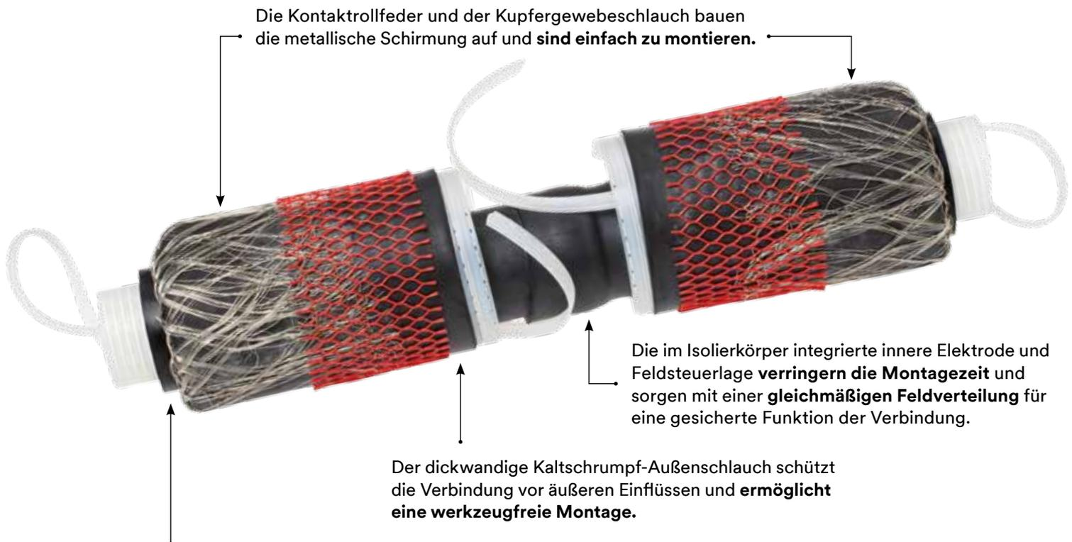
Die einteilige, kompakte Bauweise benötigt eine kurze Parkposition auf dem Kabel und **ermöglicht eine schnelle und sichere Montage auch in beengten Räumlichkeiten.**
