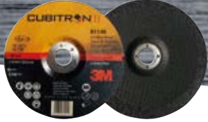
CUBITRON II 3M™ キュービットロン™ II オフセット砥石 PN81148 外径180mm×厚み4.2mm グレード:36+ 結合度:S 最高使用回転数:8,500r.p.m(80m/s)
