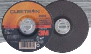
CUBITRON II 3M™ キュービットロン™ II オフセット砥石 PN85938 外径100mm×厚み4.2mm グレード:36+ 結合度:S 最高使用回転数:13,750rpm(72m/s)
