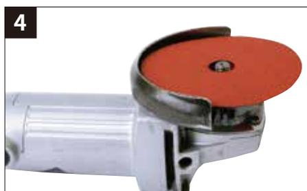
ファイバーディスクをバックアップパッドの上から回転シャフトに挿入します。
