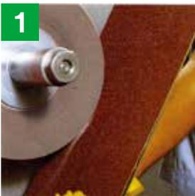
「3M™ フレキシブルダイヤモンドドレッシングシート6648J<sup>※1</sup>」あるいは「3M™ ドレッシングシート#36」を木板、鉄板等に貼り付け、それを回転しているコンポリュートホイールフラップブラシに軽く押し付け、心ぶれがなくなるまで外周面を削ってください。
