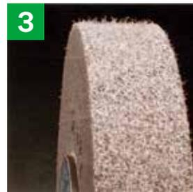
このとき、ホイール・ブラシの表面には、研磨砥粒の取れた繊維(ケバ)が残りますので、このままでは研磨性能が低下し、作業効率を悪くします。ケバ取りを行う必要があります。
