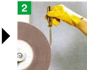
ドレッシングが正しく行われたかどうかは、ドライバーのような棒の先端をホイール、ブラシに軽く当てて検査を行います。このとき、跳ね返り、振動がなければ正しくドレッシングが行われ、偏心が修正されたことになります。
