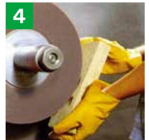
硬い木片の先端が側面をホイール、ブラシに強く当て、ケバを焼き切ってしまう<sup>※2</sup>。木片が焦げたり、ホイールの切りくずが出ればケバ取り作業が終了し、これで研磨性が高まり、効率の良い作業が可能になります。このドレッシング作業を偏心の修正のときだけでなく、通常の作業中にも行うと、より効率的です。
