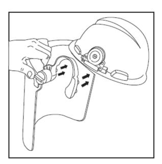
5. Após a montagem da lente, encaixe o conjunto da máscara de proteção facial no adaptador ou no abafador. Os 4 conectores devem encaixar completamente nos orifícios do adaptador/abafador.
