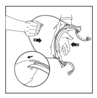
4. Gire a lente da máscara de proteção facial de modo que sua parte central se encaixe na trava existente do suporte/suspensão. Com pressão manual, trave a lente da máscara de proteção facial. Para remoção, destrave o mecanismo de trava da lente da máscara de proteção facial com as mãos, gire o visor em 30° alinhando o orifício em forma de estrela com o pino de mesma forma e remova a lente da máscara de proteção facial.
