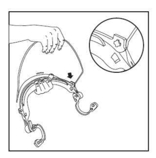
3. Com a lente da máscara de proteção facial inclinada a aproximadamente 30° em relação à parte plástica do suporte/suspensão, alinhe o orifício em forma de estrela da lente da máscara de proteção facial com o mesmo formato em alto-relevo na parte plástica do suporte/suspensão. Encaixe os orifícios de ambos os lados. A lente da máscara de proteção facial deve ficar na parte de trás da flange.
