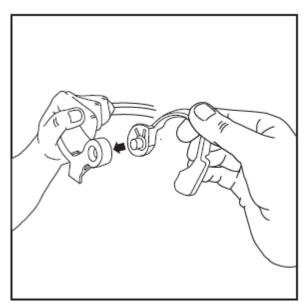
1. Segure a aba e encaixe o eixo de um dos conectores no lado interno do orifício lateral da aba. O conector deve estar posicionado com os encaixes do adaptador/abafador voltados para o lado interno da aba, caso contrário monte o conector no orifício lateral do outro lado.
