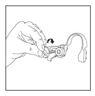
2. Introduza o parafuso no eixo e o rosqueie para unir a aba ao conector. Repita a operação para o outro conector.
