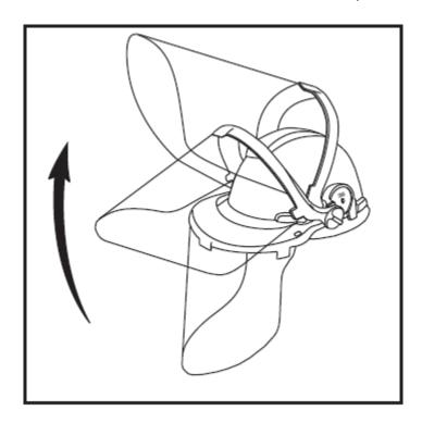
6. Este produto possibilita o uso em 3 posições diferentes. Quando definida a posição de uso, os dois parafusos laterais devem ser apertados para que a máscara de proteção facial se mantenha na posição desejada.
