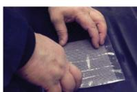
Corte una porción de Malla de Refuerzo Duramix™ de 3M (PN04904) 38 mm más larga que el daño, retire el forro de la malla y separe la malla para utilizarla en los próximos pasos.
