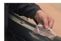
Presione inmediatamente el adhesivo y la hoja para insertarlos en el área de reparación mientras pliega la hoja y genera la forma de la lengüeta. Fuerce el material de reparación a través de los orificios que se perforaron en el paso 3.
