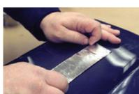
Utilice una cinta para reparación de carrocería en la parte frontal de la pieza, cubriendo el medio, para evitar que el material de reparación de la parte posterior fluya hacia la parte frontal.
