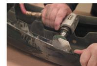
Pula y dé forma a la lengüeta hasta lograr las dimensiones deseadas con el Abrasivo Roloc™ de 3M grano 50.
