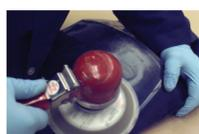
Pula el área de reparación con un disco 3M Clean Sanding grano 80, tomando como precaución no dañar el resto de la pieza que no está implicada en la reparación. Finalice el proceso con un disco 3M Clean Sanding grano 180.
