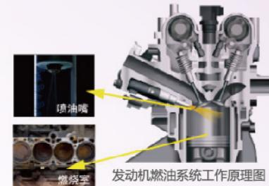
发动机燃油系统工作原理图
