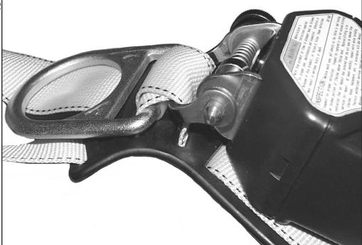
**3.6 USO DE LA SRL:** Conecte la SRL a un anclaje adecuado. Conecte el gancho o el mosquetón de la SRL al conector adecuado de su arnés de cuerpo entero. Asegúrese de que el gancho o mosquetón esté cerrado y trabado dentro del conector del arnés.
