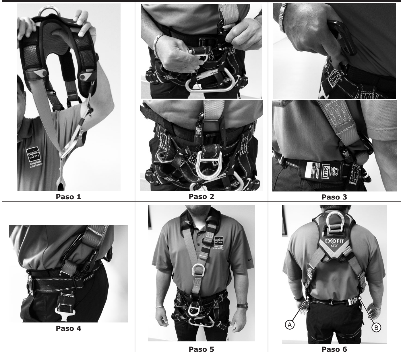
Figura 6 - Aplicaciones de incendios y rescate: sujeción de las correas para hombros
