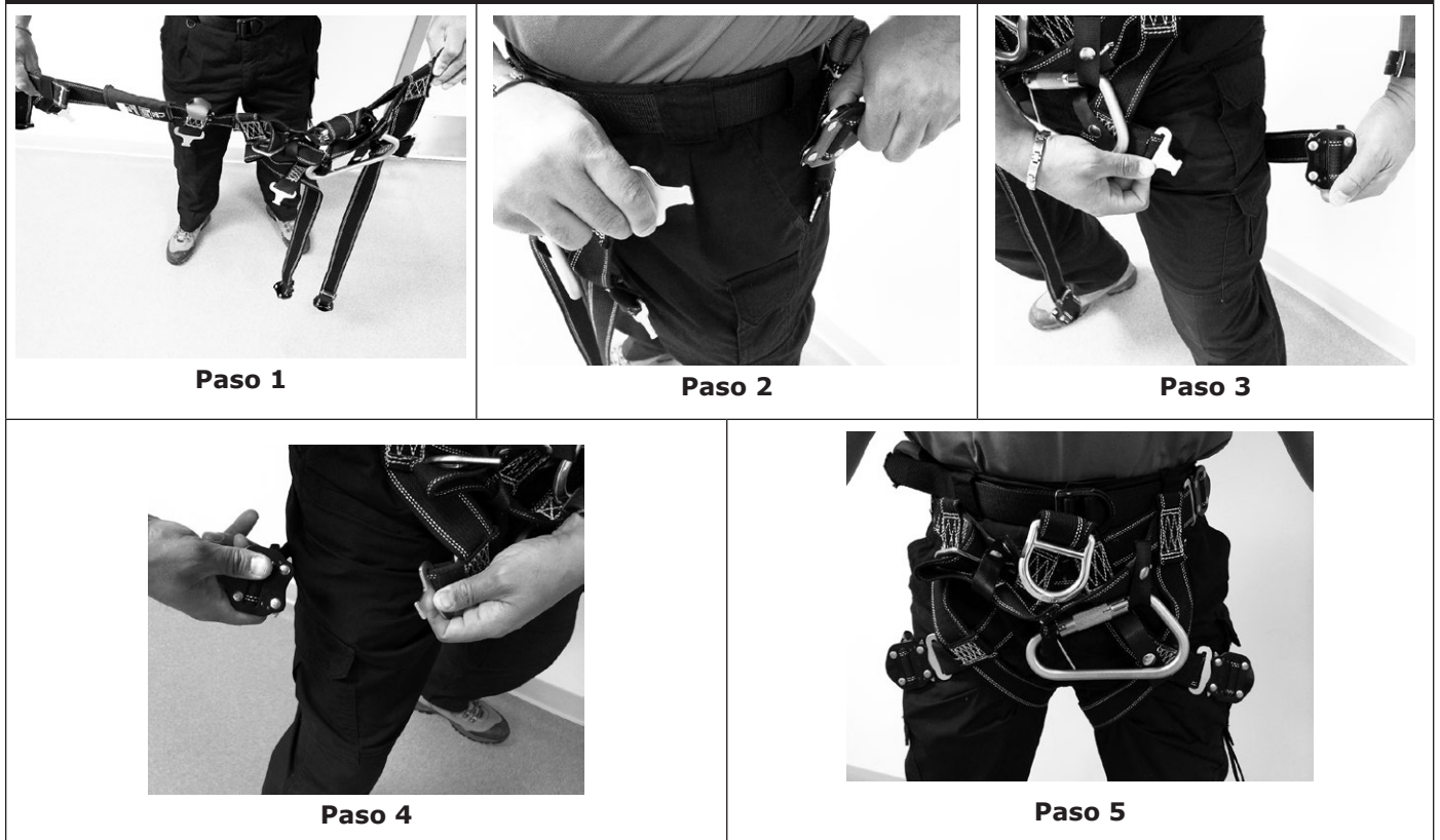
Figura 5 - Aplicaciones de incendios y rescate: configuración de la correa para rescate
