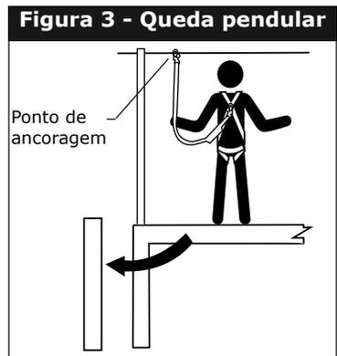
de ocorrer ferimentos. As quedas pendulares aumentam significativamente a folga exigida quando for usado um trava-queda retrátil ou outro subsistema de conexão de comprimento variável. Se houver uma situação de queda pendular em sua aplicação, entre em contato com a DBI-SALA antes de continuar.
