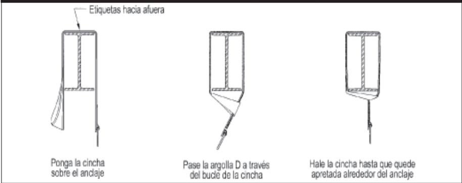
**Figura 15 - Instalación de la eslinga de cable para anclaje**
