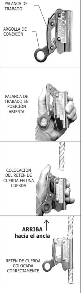
palanca de trabado y suelte la cuerda de la zapata de freno. Hale hacia arriba la cuerda que pasa por el retén de cuerda mientras la palanca de trabado está en la posición tope. Cuando haya llegado a su nueva posición, suelte la palanca de trabado y el retén se trabará agarrando la cuerda.
