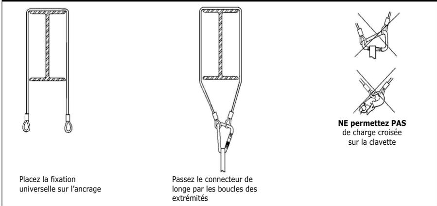
Figure 10 - Installation de la fixation universelle avec cordon à double anneau
