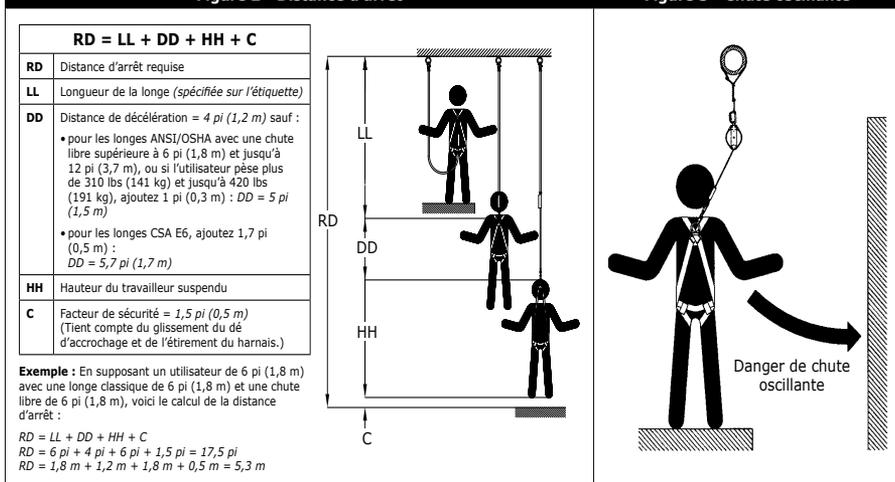
**C. DISTANCE D'ARRÊT :** la figure 2 illustre les exigences en matière de distance d'arrêt. Assurez-vous que le dégagement en cas de chute est suffisant pour éviter tout contact avec un objet. Si le travailleur doit opérer dans une position qui ne se trouve pas directement sous le point d'ancrage, le dégagement et la distance de chute verticale seront plus grands. La hauteur du dégagement dépend des facteurs suivants :
