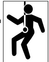
**E. RETENUE :** Le harnais de sécurité complet est utilisé comme composant d'un système de retenue permettant à l'utilisateur d'éviter tout danger de chute. Les systèmes de retenue comprennent généralement un harnais de sécurité complet et une longe ou une corde de retenue.
