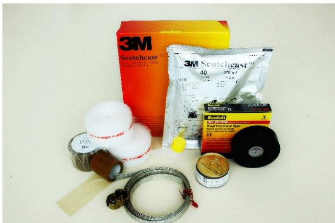
Рис. 7 Компоненты муфты 3М™ GTS: полиуретановый компаунд, сетчатая и прозрачная ленты для формирования корпуса, клапан для заливки компаунда, поводок заземления и пружинные кольца, комплект для очистки и обезжиривания кабеля, стойкая ПВХ-лента Scotch® 22 для защиты от ультрафиолета
