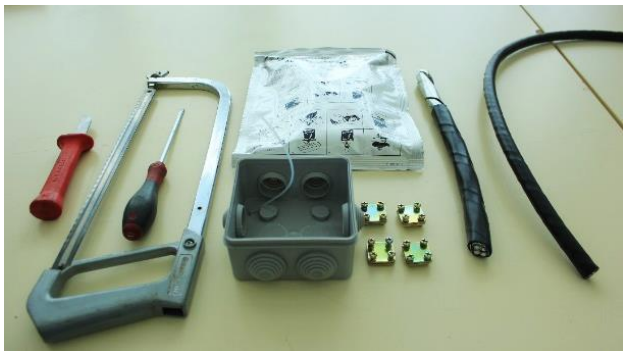
Рис. 15 Набор материалов для герметизации ответвления кабеля в распаячной коробке: пила и нож для разделки изоляции кабеля, отвертка для установки соединителей, соединители болтовые, распаячная коробка, компаунд Scotchcast® производства компании 3M
