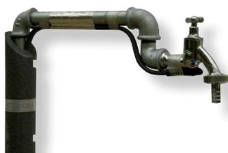
SLRB wird unter der Wärmedämmung gestreckt auf das zu beheizende Rohr montiert. Der Parallel-Aufbau ermöglicht die einfache Montage und ein Ablängen des Heizbandes vor Ort. Die Vorkonfektionierung entfällt.
