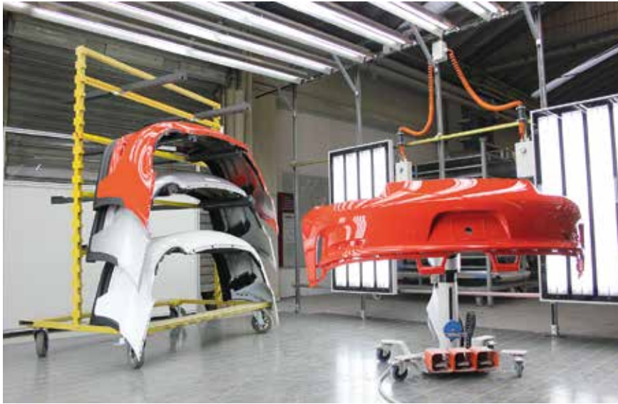
Bild 2. Einblick in die Produktion der Heckschürze in Hörsching. Hier werden die Bauteile nicht nur gefertigt, sondern auch einer individuellen Class-A-Lackierung unterzogen. Der Standort ist auf die Produktion von Automobil-Exterieur-Bauteilen in Kleinserien spezialisiert (© Polytec Group)
