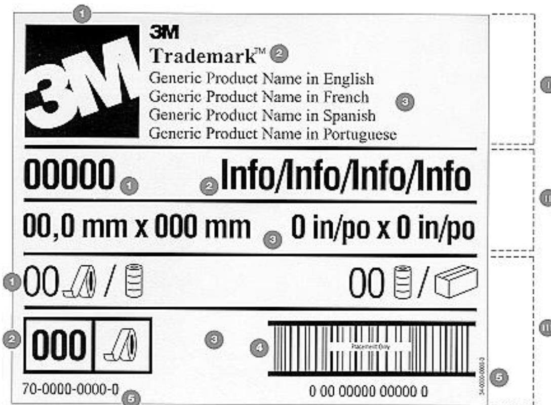
L'étiquette standard 3M se compose de trois zones (notées sur le schéma I, II, III).
