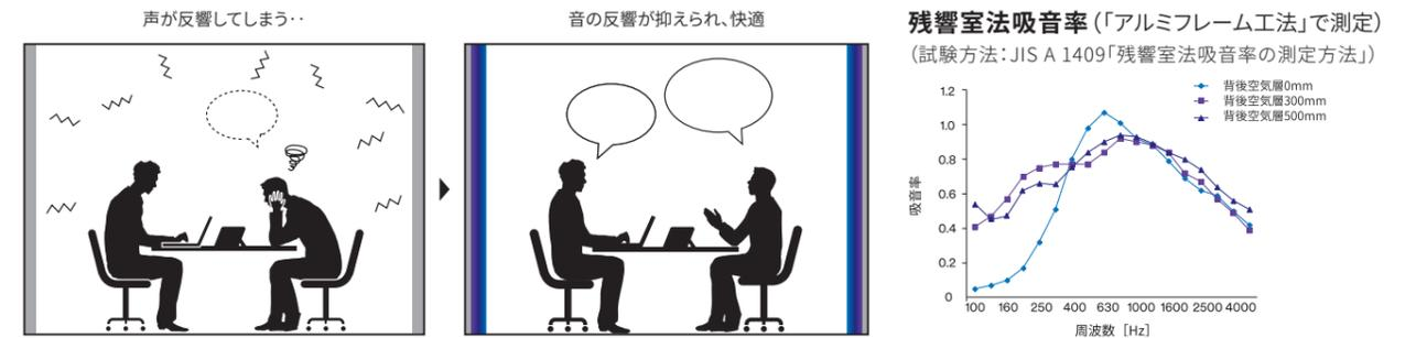
※残響室法吸音率では、残響時間から逆算して吸音率が算出されるため、値が1を超える場合があります。
