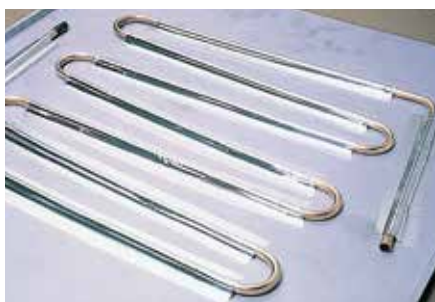
ヒートパイプの固定
