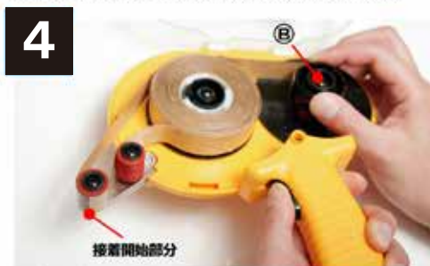
4 黒色の引き金を引きながら(B)を回し、ローラーの先端に接着開始部分を合わせます。
