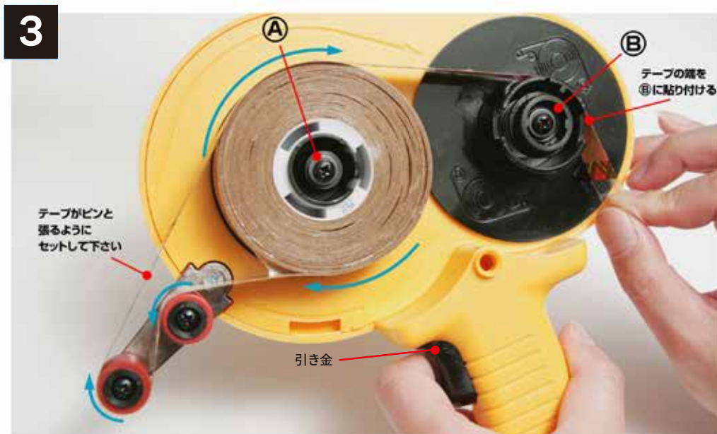
3 (A)の3本ツメにテープ芯をはめ込み、黒色の引き金を引きながら上記のようにテープを通し、テープ端を(B)に巻き付けます。 ※テープを通す際、テープがたるまないように注意してください。
