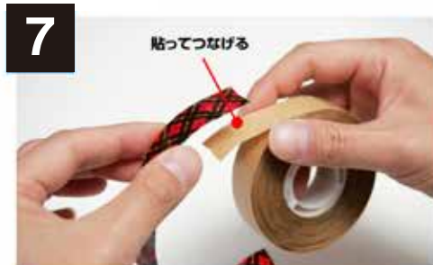
7 途中でテープが切れた場合はテープ最初の赤いチェック部分につなぎ直し、最初からセットし直してください。
