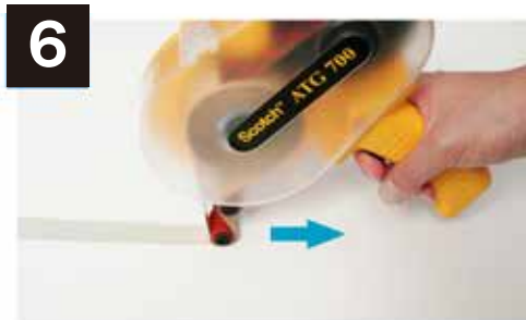
6 黒色の引き金を引きながらテープを貼ります。テープを切る時は、引き金を離し、アプリケーターをそのまま手前方向に引いてテープを切ってください。(アプリケーターを上から離してテープを切らないようにしてください。)
