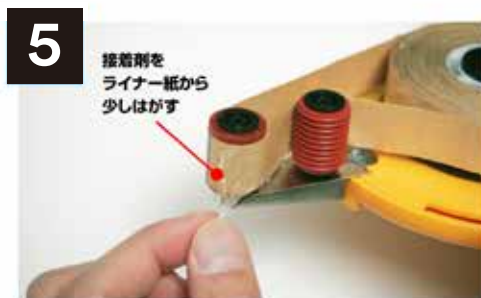
5 接着開始部分の端を、カッターで軽く切るか、指ではがします。
