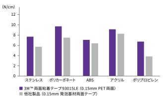
同じ0.15mm厚の発泡基材両面テープと比較しても、 各種被着体に対して高い接着力を発揮します。
