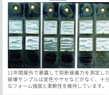
11年間屋外で暴露して剪断接着力を測定した破壊サンプルは変色やヤセなどがなく、十分なフォーム強度と柔軟性を維持しています。
