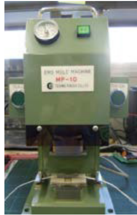
専用プレス機 2 で接続部を圧接する (3~5kg/cm 2 、4~5秒)
