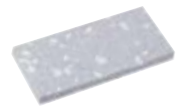
メラミンフォームが摩 耗し、裏側の白い不織 布が露出。新しい製品 と交換してください。
