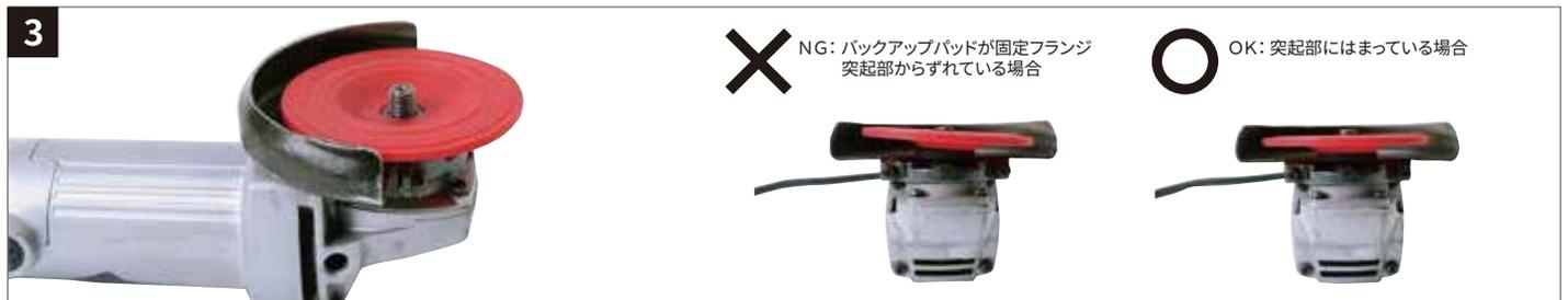
バックアップパッドを回転シャフトに挿入します。※バックアップパッドは固定フランジ突起部にはまるよう位置を調整します。
