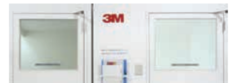
一般市販品壁紙 反射率: 85% 照度: 364Lx 照度向上率 約2.1倍 IL-1852 反射率: 95% 照度: 806Lx
