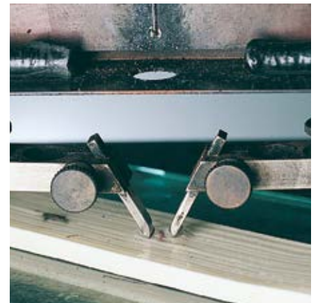
水性汚染液と高電圧探針による CTI 試験
