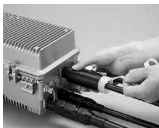
2. チューブを回しながらコアを引き、チューブを収縮させ位置合わせをします。
