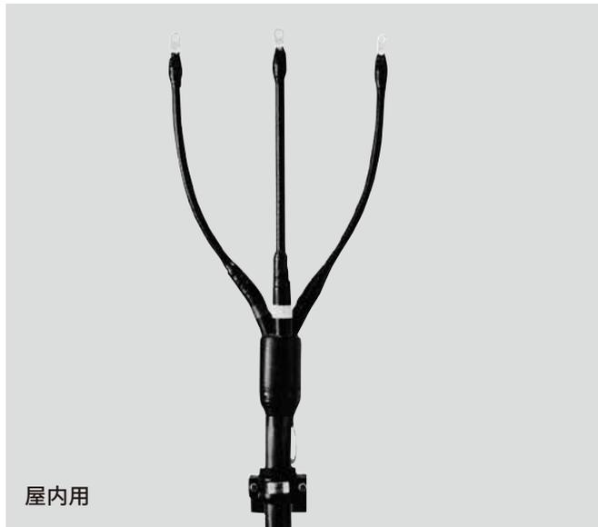
3.3kVケーブルの端末処理工法は、テープ巻きが少なく、特にCV3心ケーブル用キットは三又分岐部をゴムチューブによりモールドすることで、簡単にしかも短時間で組立てることができます。
